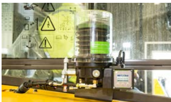
EcoPlus är ett centralsmörjsystem som STS monterar på kompaktmaskiner upp till 10 ton.
